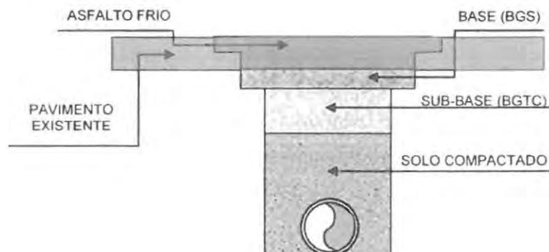
A recomposição do terreno em torno do gasoduto deve ser feita com material de primeira qualidade ou o mesmo existente. A sub-base deve ser composta de brita graduada tratada com cimento e a base com brita graduada simples.
